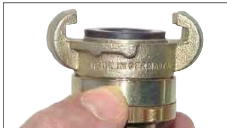
Vorgeschraubte Dichtung - Verbindung ist dicht.
